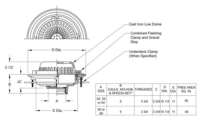
Fig. 1010C(-LPD) . . . . CAULK OUTLET Fig. 1010Y(-LPD) . . . . NO-HUB OUTLET Fig. 1010T(-LPD) . . . . THREADED OUTLET
